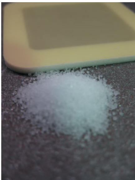
Bild 2. Maximal lösbare Salzmenge in einem Bresle-Pflaster
