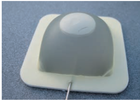
Die Testpflaster durchlaufen in der Fertigung bereits mehrere Waschzyklen, damit keine Salzurückstände aus dem Produktionsprozess verbleiben und das Messergebnis verfälschen
