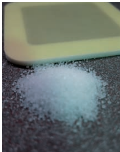
Verunreinigungen durch Salz auf dem Substrat führen zu Beschichtungsfehlern
